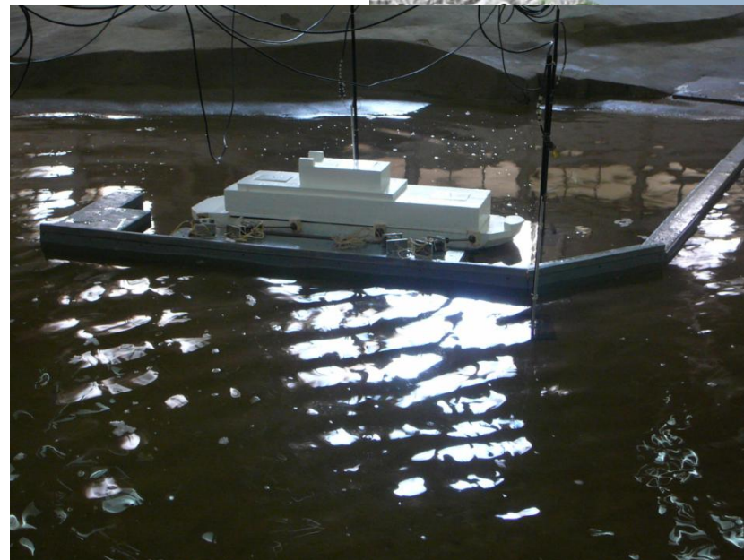
Модель плавучей атомной теплоэнергетической станции (ПАТЭС) в масштабе 1:100
