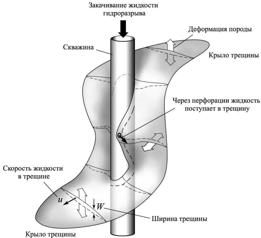
Рис. 1: Процесс гидроразрыва пласта
