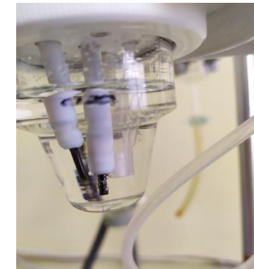
Рис.6. Ячейка для ВА-измерений, стеклоуглеродные индикаторный и вспомогательный электроды, хлоридсеребряный электрод сравнения.
