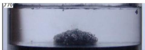
Рис. 2. Промежуточный кадр состояния разрыва на стадии его сжатия,  $t = 770$  мкс, диаметр кюветы 4 см, высота водяного столба 1.5 см, время экспозиции 1 мкс, энергия нагружения 50 Дж.
