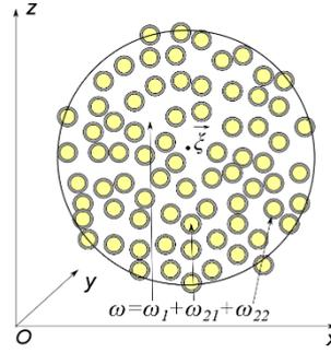
Определение макрообъема для проведения осреднения основных уравнений (Охуз – лабораторная система координат;  $\bar{\xi}$  – фиксированная точка пространства;  $\omega_1$  – часть объема, не занятая микросферами;  $\omega_2$  – часть объема, занимаемая полостями всех микросфер;  $\omega_{22}$  – часть объема, занятая твердой оболочкой микросфер)
