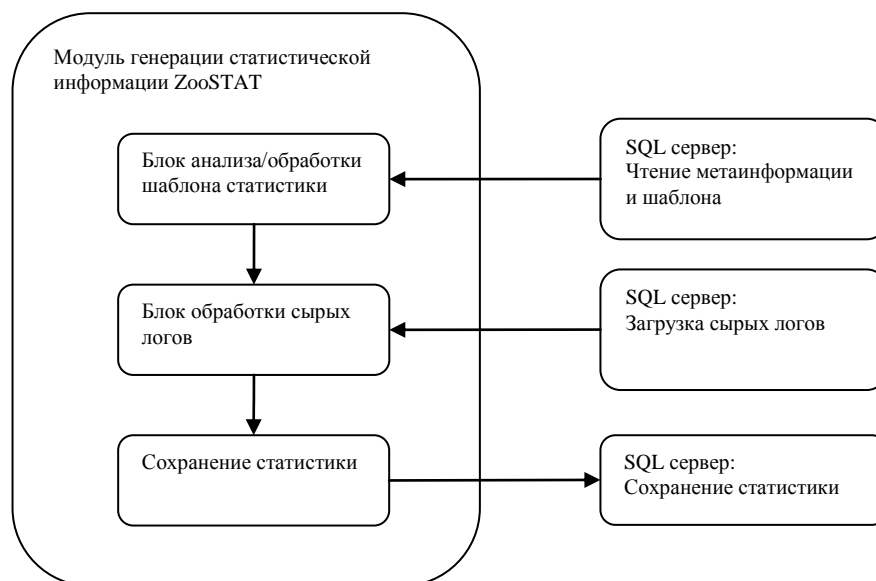
Рис. 4. Архитектура модуля генерации статистической информации.
