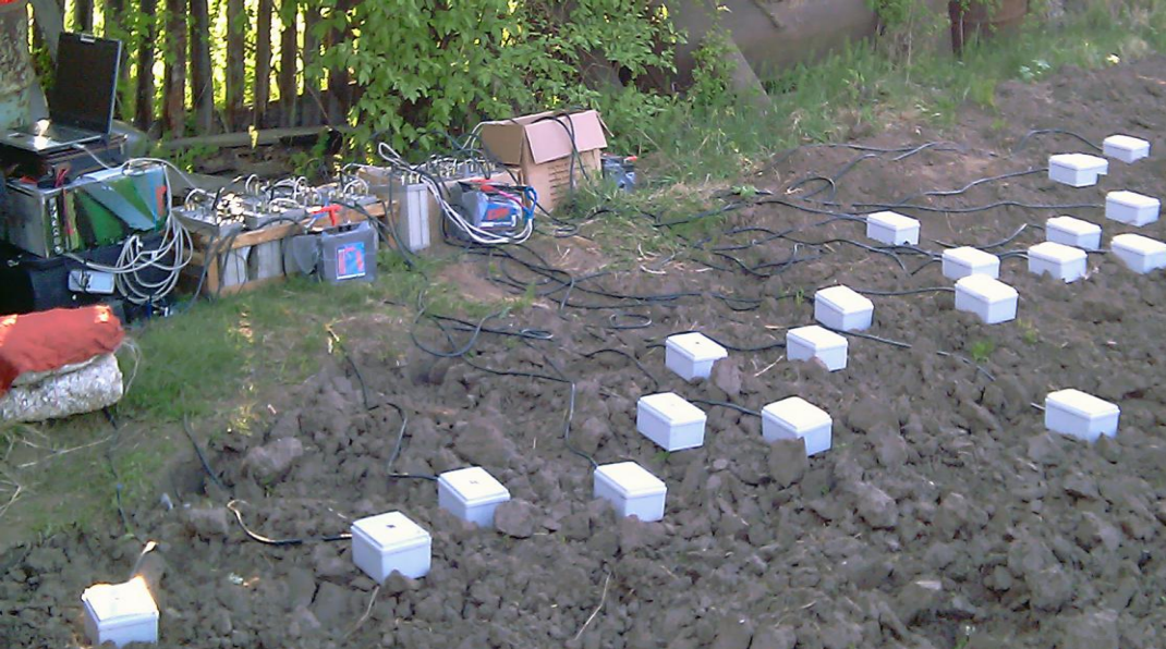
Настройка регистраторов МГР-01
