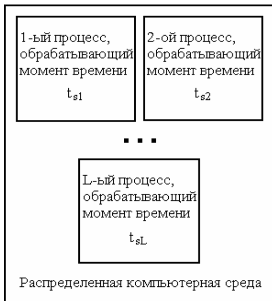
Рис. 1. Схема работы параллельных процессов в распределенной компьютерной среде.
