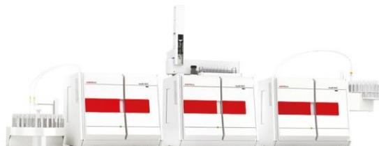
Элементные анализаторы **AnalytikJena multiEA** и **multi N/C** для определения C, N, S, Cl и суммарных параметров TOC, EOX, AOX/TOX в твердых, жидких и газообразных образцах. Модульная конструкция под конкретную аналитическую задачу с возможностью устанавливать дополнительные модули. Детекторы работают в широком диапазоне концентраций: от ppb до %. Технология стабилизации газовых потоков гарантирует высокую воспроизводимость результатов и стабильность калибровки во времени.
