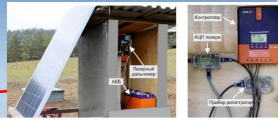
**Наземная часть** деформометрической станции
