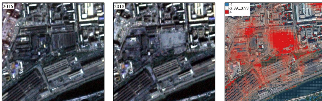
Рис. 3. Изменение температуры поверхности земли на территории «Комбайнового завода» в г. Красноярске с 2016 по 2018 годы.
