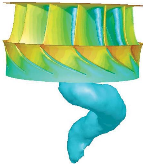
Рис. 6. Вихревая структура течения в турбине
