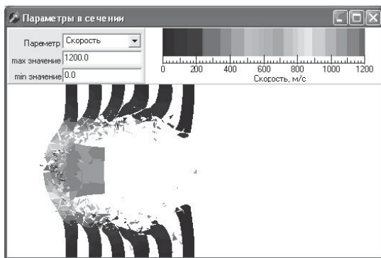
Рис. 8. Взаимодействие ударника и преграды в момент времени 40 мкс. 2-D сечение системы преграда-ударник (скорость)
