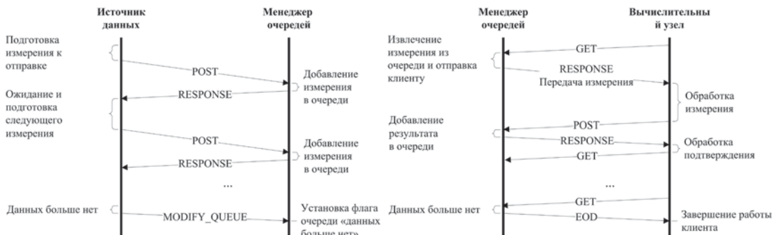
Рис. 5. Временная диаграмма работы протокола PIV
