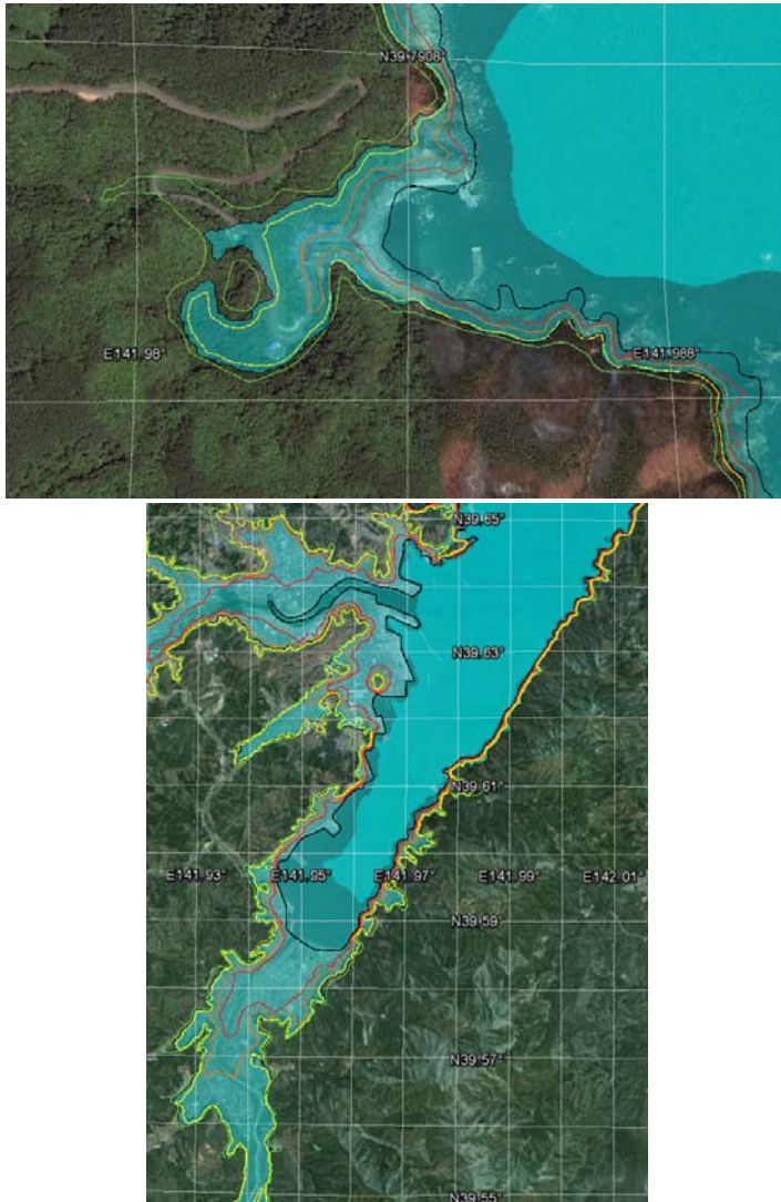
Рис. 8. Зоны затопления волной цунами 2011 г. (Tohoku) побережья бухт Коборинаи (сверху) и Мияко (снизу) (голубая заливка), полученные в результате двумерных расчетов и наложенные на изображение Google Earth. Цветными линиями показаны изолинии цифрового рельефа суши: черная - 0 м, красная - 5 м, оранжевая - 10 м, желтая - 20 м, зеленая - 30 м.
