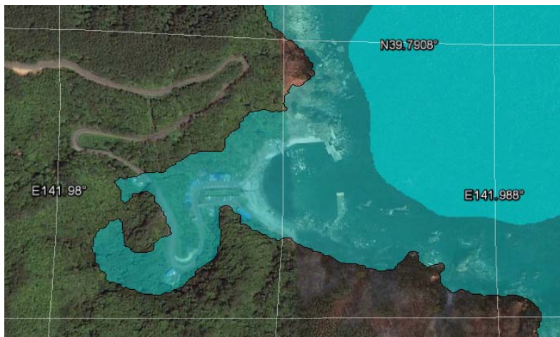
Рис. 6. Область затопления волной цунами (Tohoku, 2011 г.) побережья бухты Коборинаи (голубая заливка), полученная в результате расчетов и наложенная на изображение Google Earth.
