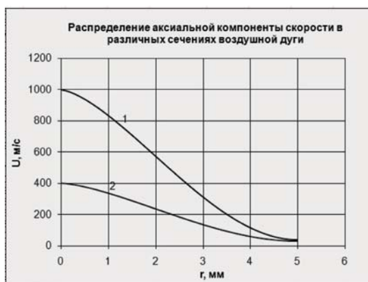
Рис. 3. Профили скоростей по сечению воздушно-дуговой плазмы: 1- z = 8 мм; 2- z = 15 мм;
