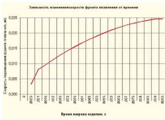
Рис. 9. Изменение температуры поверхности во времени. Рис. 10. Скорость движения межфазной границы плавления.
