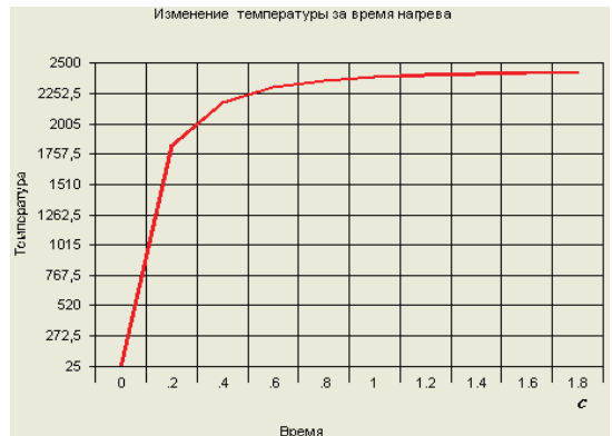
Рис. 9. Изменение температуры поверхности во времени. Рис. 10. Скорость движения межфазной границы плавления.
