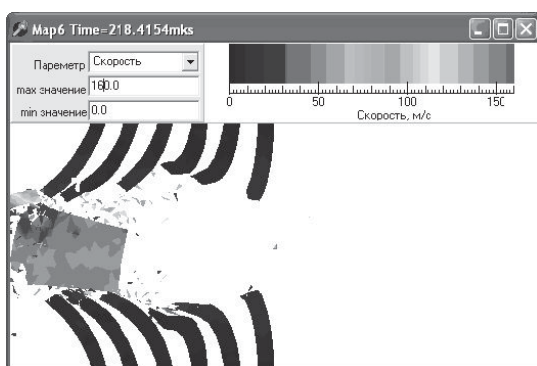
Рис. 9. Взаимодействие ударника и преграды в момент времени 220 мкс. 2-D сечение системы преграда-ударник (скорость)
