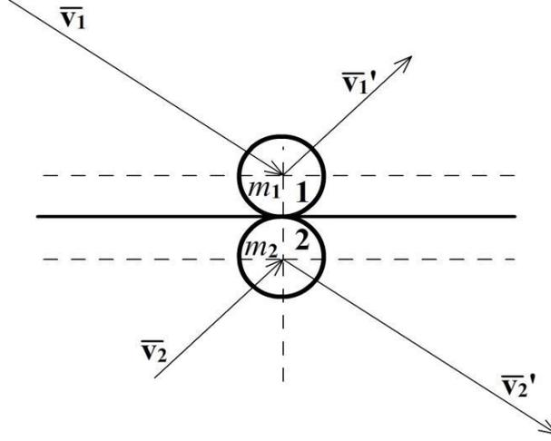
Рис. 2. Столкновение двух частиц;  $m_1, m_2$  - массы частиц;  $\mathbf{v}_1, \mathbf{v}_2$  - скорости движения частиц до столкновения;  $\mathbf{v}'_1, \mathbf{v}'_2$  - скорости после столкновения.
