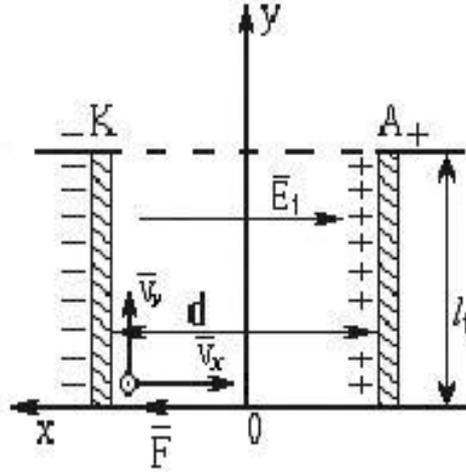
Рис. 1. Движение частицы:  $l_1$  – длина пластин электродов;  $d$  – расстояние между пластинами;  $\mathbf{v}_x, \mathbf{v}_y$  – проекции вектора скорости по осям  $X$  и  $Y$ ;  $K$  – катод;  $A$  – анод.
