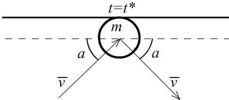
Рис. 3. Изменение направления движения частицы при ударе о стенку:  $m$  - масса частиц;  $\mathbf{v}$  - скорость движения частиц;  $a$  - угол падения частицы.
